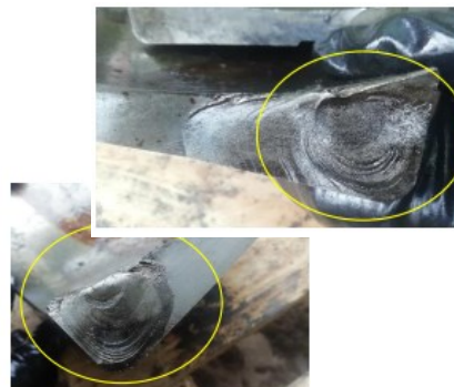
Zonas do anel externo já com fissuras existentes tendo fraturado totalmente durante o processo de desmontagem
