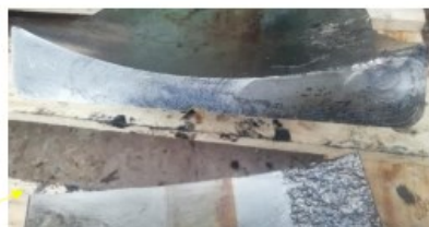
Anel externo do rolamento retirado de serviço (aspecto da zona fraturada)
