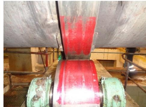
Fig. 5 – Contacto da superfície dos roletes com a bandagem
