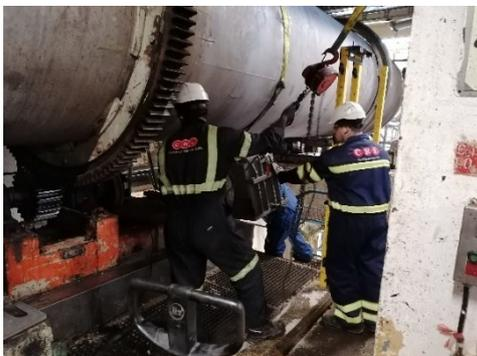
Fig. 6 – Substituição do redutor
