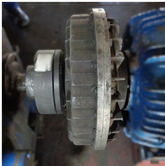
Fig. 1 – Acoplamento hidráulico montado no equipamento
