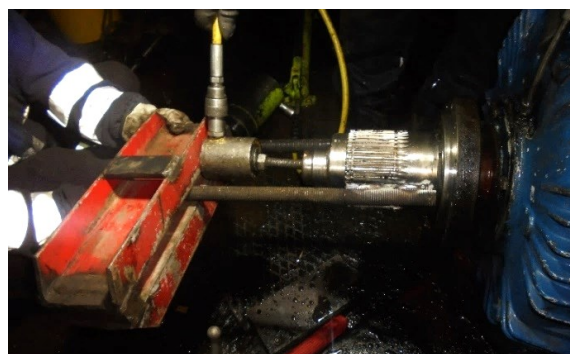
Fig. 3 – Remoção de acoplamento hidráulico
