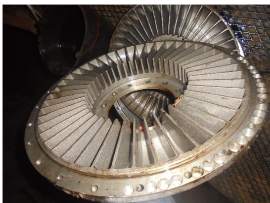
Fig. 2 – Acoplamento hidráulico desmontado para aceder a cubo interior
