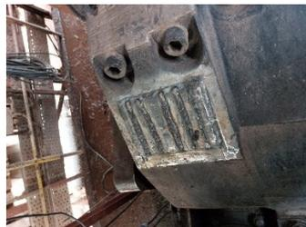
Fig. 4 – Padrão de enchimento com material duro
