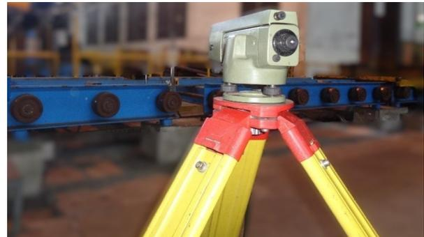
**Fig. 3** – Verificação de nivelamento de rodas de apoio de carris de transporte
