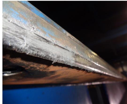
**Fig. 1** – Carril de deslocação de roda com desgaste severo
